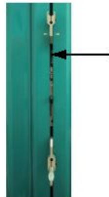
2. 用测力计检测浮动测头悬架。把测力计的杠杆与测头相接触。移动其中一个直到听到声音信号，读出测力计显示的读数。用反方向移动重复上述步骤。比较结果，如有必要，可再进行调节。两个方向一定要平衡（即有相等的数值）。
