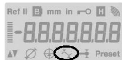
2.把测头放到待测的曲面上，并沿着所测部分移动仪器（或零件）。
