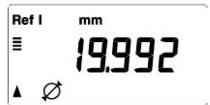
4a.竖直向上移动测头,并尽可能近地把它移动到上侧面上并接近拐点(3)。横向移动仪器或工件来确定拐点(4)。就会显示出直径值来。
