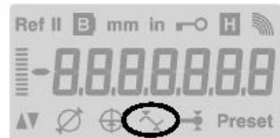
2.把测头放到待测的测量面上，并沿着所测部分移动仪器（或零件）。
