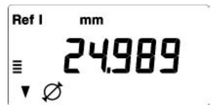
4b.把测头放到轴上方,并尽可能近地把它接触到上侧面并接近拐点(3)。横向移动仪器或工件来确定拐点(4)。就会显示出直径值来。
