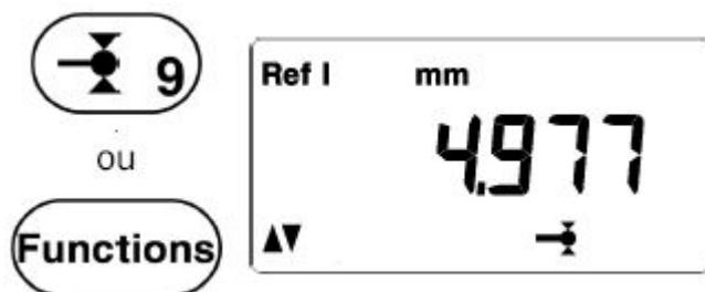
4. 摇动移动手轮，把测头移动到设定规的一组平面的下平面上，直到“嘀”的一声确认。
